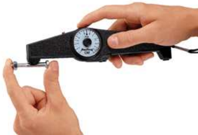
Slika 2.16 Uređaj za merenje debljine prevlake magnetnim povlačenjem
